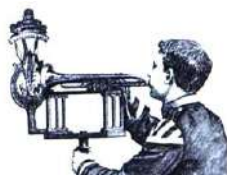
Мал. 2. Динамометр Й. Шедіви «Інструкція для виробництва», 1896 [20; 61].
